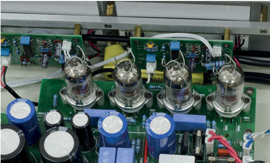
Le valvole 12AT7 e 12AU7 del front end circuitale.
